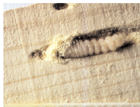
Under tiotals år kan husbocken äta sig in i splintveden innan den förpuppas sig. (Ca 2 ggr förstoring).
